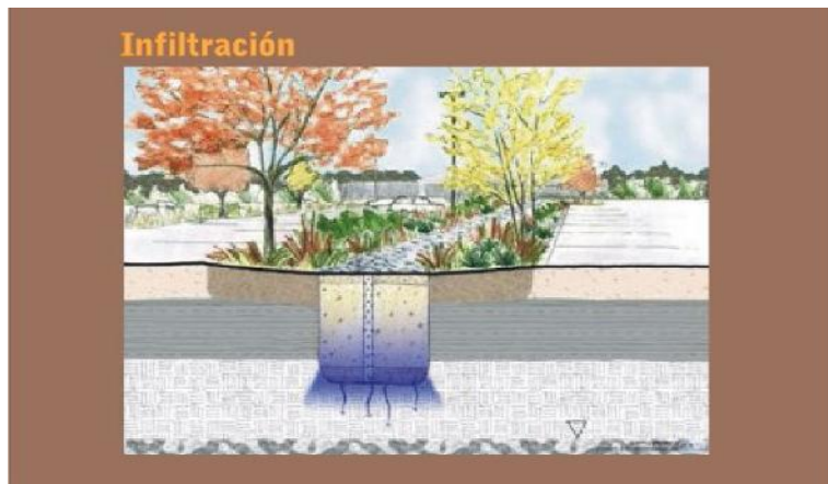
Esquemas de zanjas de infiltración y drenaje tomados de la Guía de Buenas Prácticas Ambientales de SMA, pág 23 y 24
